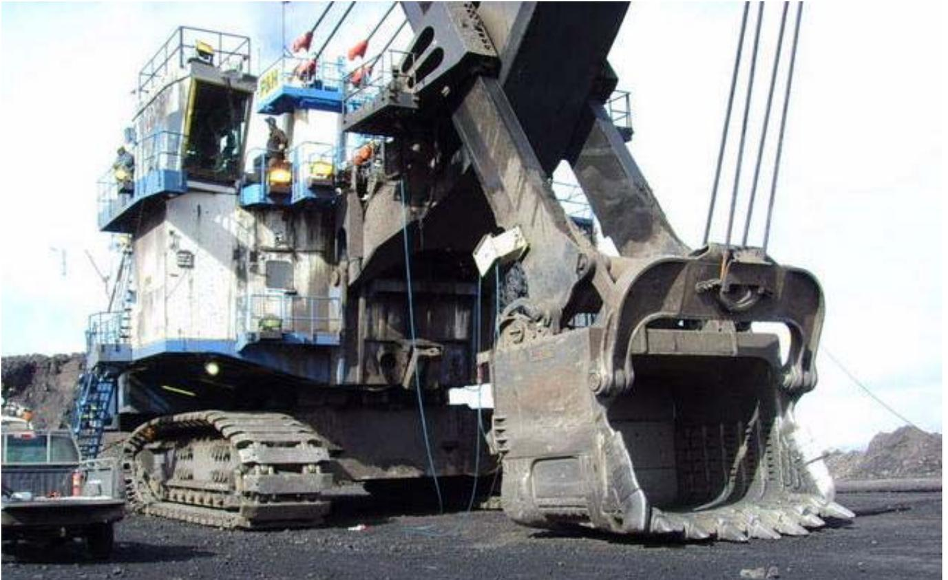
La superficie de sellado del tambor de izaje de una pala P&H 4100 de una mina ubicada 1000 km al sur de Lima se había gastado, y el aceite salía libremente de la caja reductora (y el polvo entraba ....). Por las dimensiones de la pieza (2.8 m de diámetro, 3.5 m de largo, 20 toneladas de peso), el trabajo tenía que ser hecho en sitio ...
