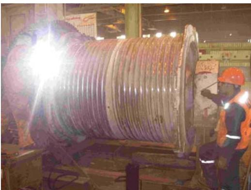
Proceso ininterrumpido de soldadura de la superficie de sellado
