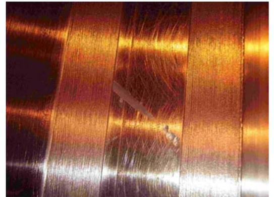
Desbastado (al mínimo) de la superficie de sellado, antes de la soldadura
